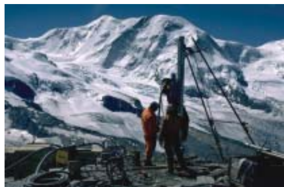
Abb. 6: Bohrung eines 100 m tiefen Bohrlochs nahe dem Stockhorn (CH, 3400 m ü. M.) oberhalb von Zermatt. Die Bohrung wurde 2000 im Rahmen des EU-Projekts PACE erstellt und seither werden darin kontinuierlich die Temperaturen des Untergrunds gemessen. Im Hintergrund sind der Grenzgletscher und der Lyskamm sichtbar. Foto W. Haeberli.
